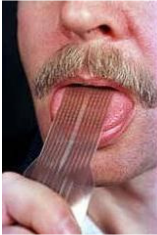
Abb. 9: Zungen-Display-Einheit wird gegen den Gaumen gedrückt
